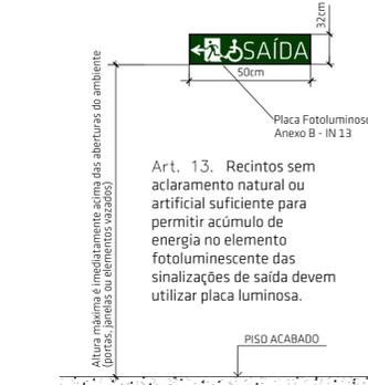
DETALHE PLACA FOTOLUMINESCENTE SISTEMA DE ABANDONO DE LOCAL (03) - IN 13 SEM ESCALA
