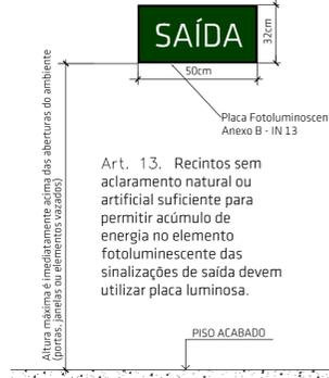
DETALHE PLACA FOTOLUMINESCENTE SISTEMA DE ABANDONO DE LOCAL (02) - IN 13 SEM ESCALA
