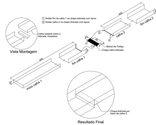
**4 DETALHE CONEXÃO E EMENDA CALHAS**
