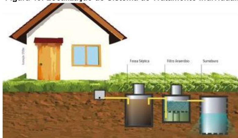
Figura 40: Localização do Sistema de Tratamento Individual.
