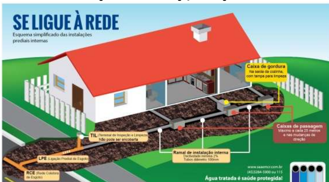
Figura 97: Padrão de Ligação de Esgoto
