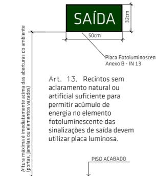
DETALHE PLACA FOTOLUMINESCENTE SISTEMA DE ABANDONO DE LOCAL (02) - IN 13 SEM ESCALA
