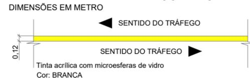
DETALHE LINHA SIMPLES SECCIONADA
